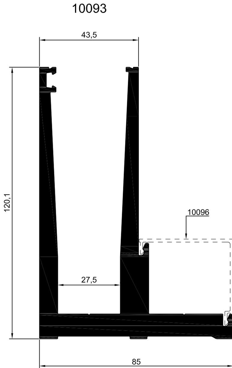
SE PUEDE SUMINISTRAR EL PERFIL CON LAS MECANIZACIONES DE ANCLAJE O DRENAJE YA REALIZADAS
